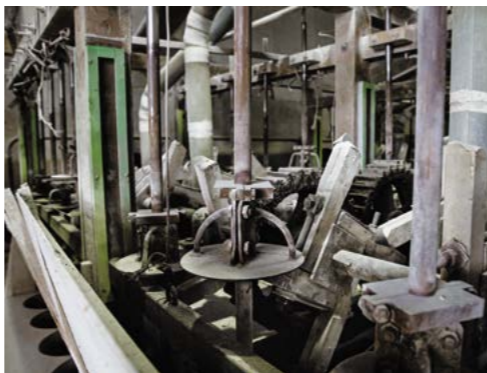
県内で唯一残るこんにやく製粉工場「佐川商店」の機械。杵と臼のような構造で、チップス状に乾燥させた芋を23時間かけて粉にする
